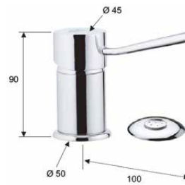
Monomando bidé Flash, cartucho 35mm con transmisión y válvula clic-clac
